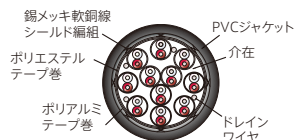
標準・耐屈曲／高撓動 ケーブル構造
