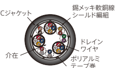
細径 ケーブル構造
